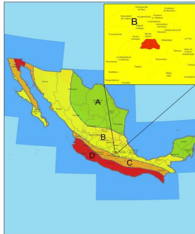
Ilustración 38. Zonificación sísmica de la CFE.
